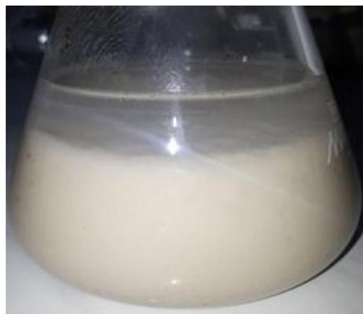
**Figure IV.15 : suspension 30 kg/m<sup>3</sup> BC + 40% gypse.**
