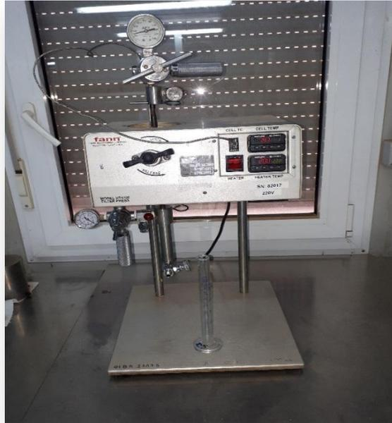
*Figure IV. 41: photo de filtre-presse HPHT.*
