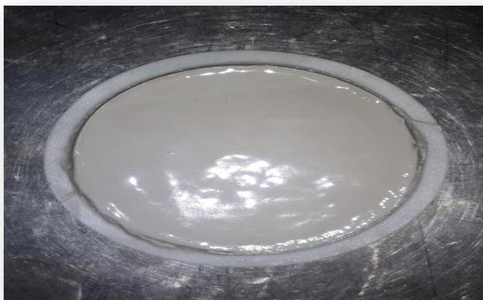
Figure IV. 44: Photo de la mesure du cake 40 kg BC + 40 %GYPSE +15% MMH + 22 kg/m<sup>3</sup> de starch modifier.
