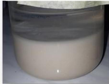
**Figure IV.27 :  $30 \text{ Kg/m}^3 \text{BC} + 30\% \text{Chaux} + 15\% \text{MMH}$**
