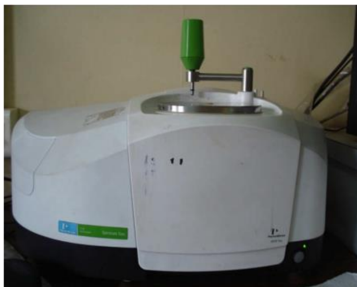
Figure III. 10. Appareil de Spectroscopie infrarouge en Réflectance Totale Atténuée (ATR/FTIR).
