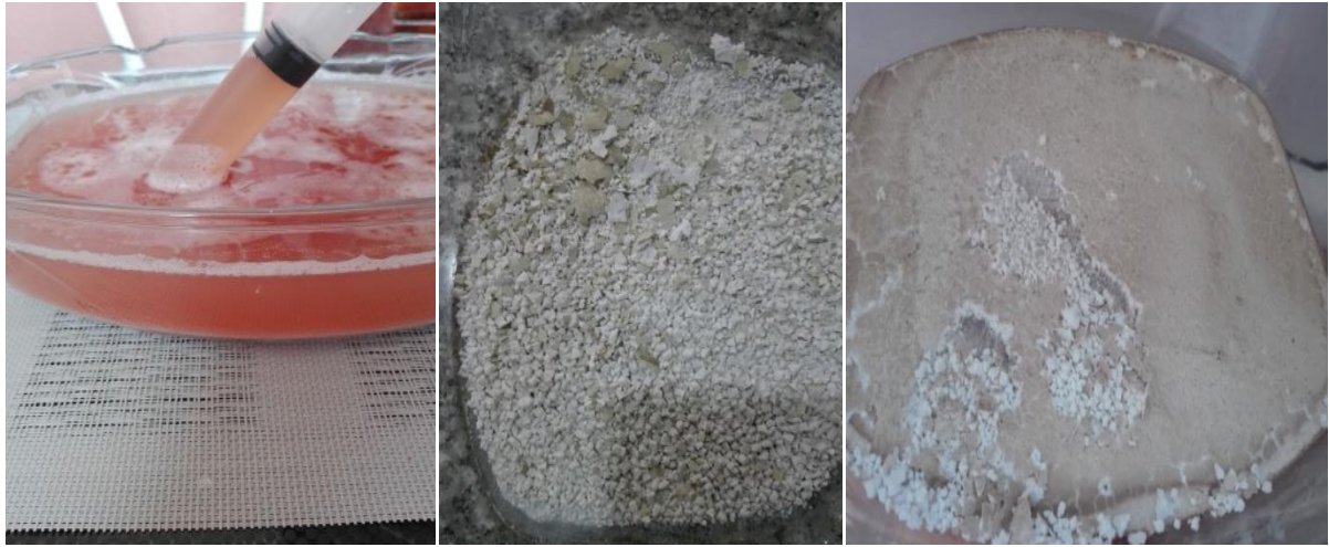
Figure III. 6. Récupération et séchage de l'amidon
