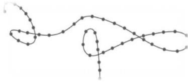
Figure I.2. Représentation schématique d'un polymère linéaire
