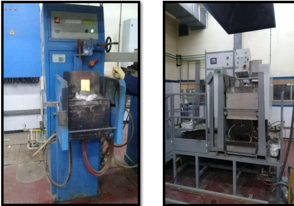
**Figure II.3 :** Fours à induction.
