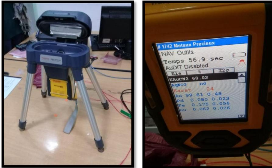
**Figure II.10 :** Appareille d’analyse XRF.
