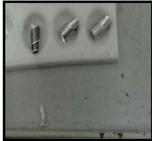
**Figure III.6 :** Boutons après laminage et recuit.
