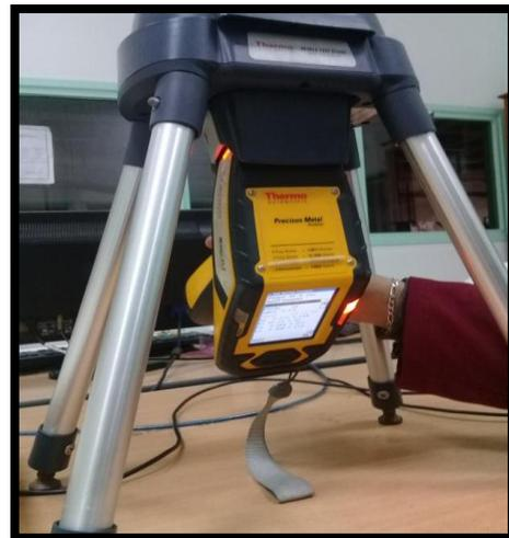
**Figure III.1 :** Analyseur X.R.F.
