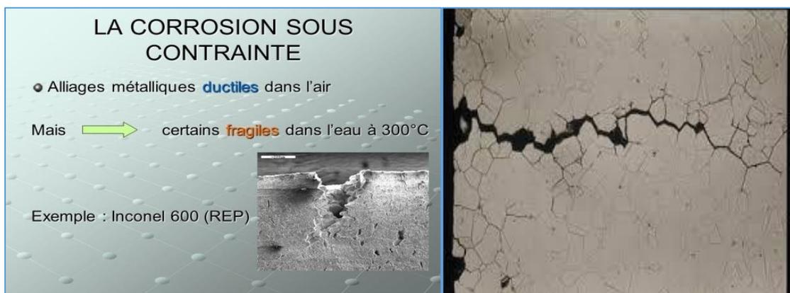
Figure 11 : mécanisme de la corrosion sous contrainte.
