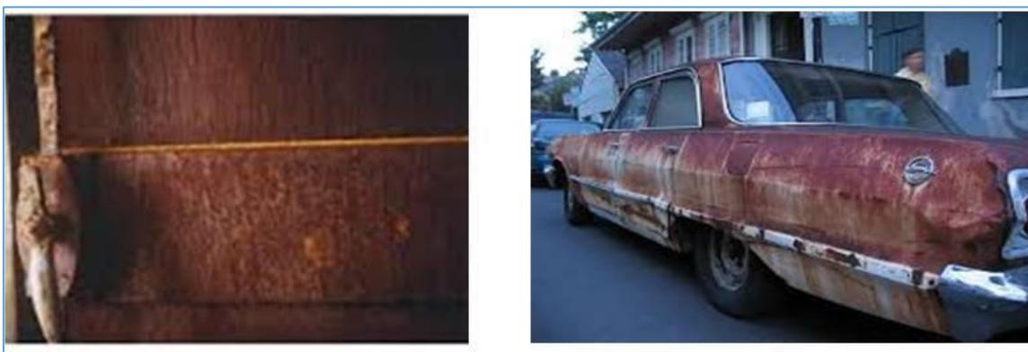
Figure 03 : Corrosion généralisée : exemple d'une porte et d'un véhicule corrodés
