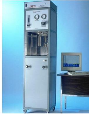
*Fig. IV.8 : Rhéomètre à haute pression et haute température Fann 50. Ce modèle est entièrement contrôlé par ordinateur, alors que les modèles précédents avaient des commandes manuelles et étaient deux fois plus grands que le modèle illustré.*
