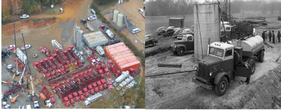
*Fig.V.1: Depuis le premier traitement de fracturation commerciale en 1949 (photo à droite), le développement du fluide de fracturation a été un objectif constant des efforts de recherche et développement de Halliburton. Équipement et les techniques évoluent constamment à mesure que l'on en apprend plus(photo à gauche) .*
