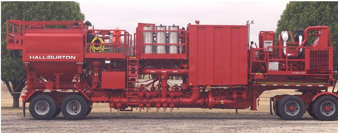
*Fig.V.1: Le mélangeur ADP: permet de mélanger n'importe quel fluide de fracturation Halliburton en utilisant une poudre sèche. Ceci élimine le besoin de tous les fluides porteurs à base d'hydrocarbures.*
