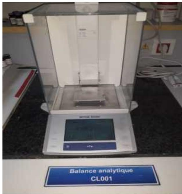
**Figure n°11 : balance analytique Metler Tolédo**
