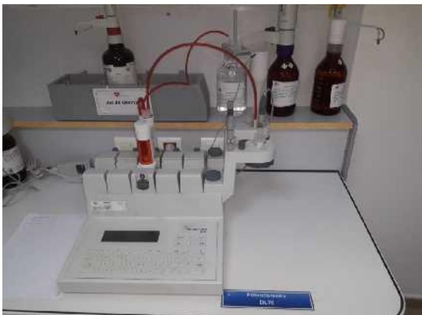
**Figure n°19 : potentiomètre Mettler Toledo**
