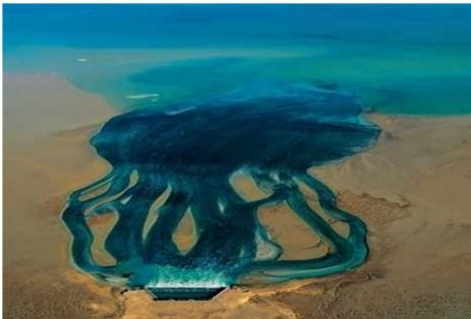
**Figure III.12 :** Rejet de l'usine de dessalement d'eau de mer d'Al-Doha, Koweït. [34]
