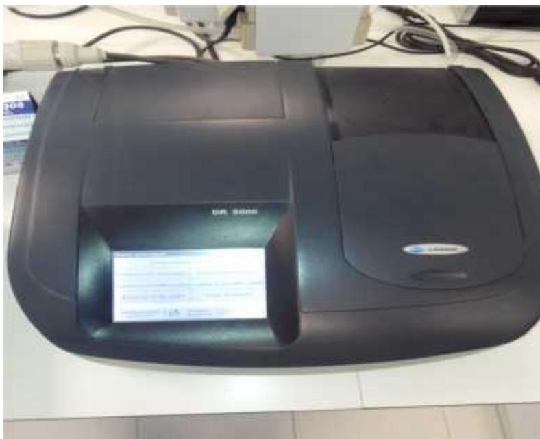
**Figure A.4 : spectrophotomètre HACH DR 5000**
