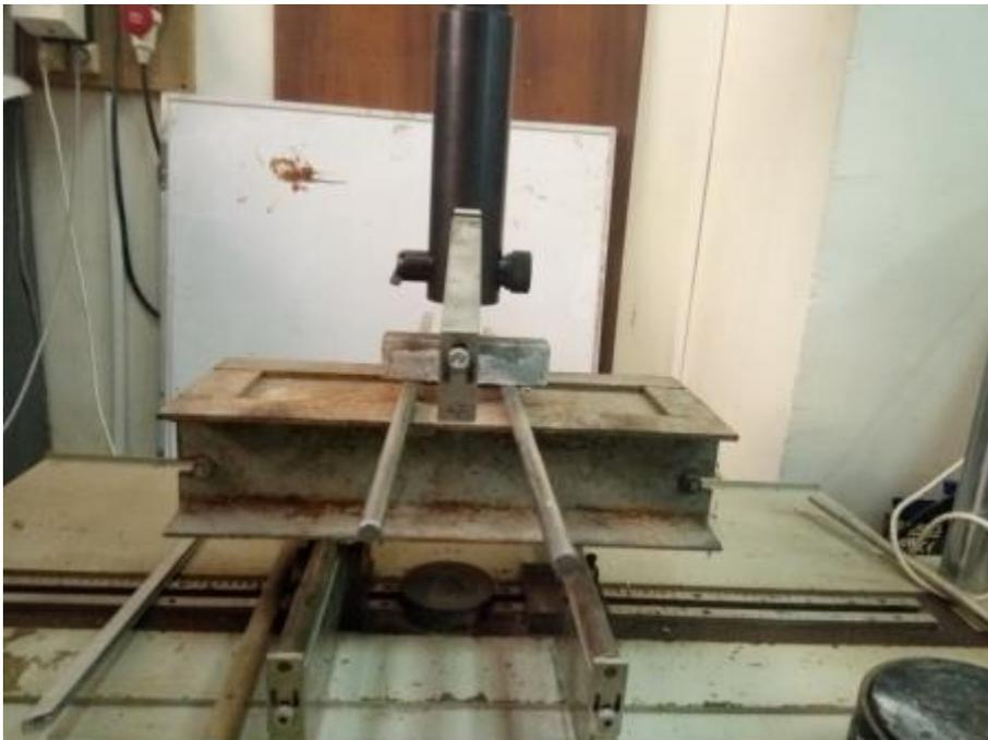
**Figure 17 : Machine pour essais de flexion**
