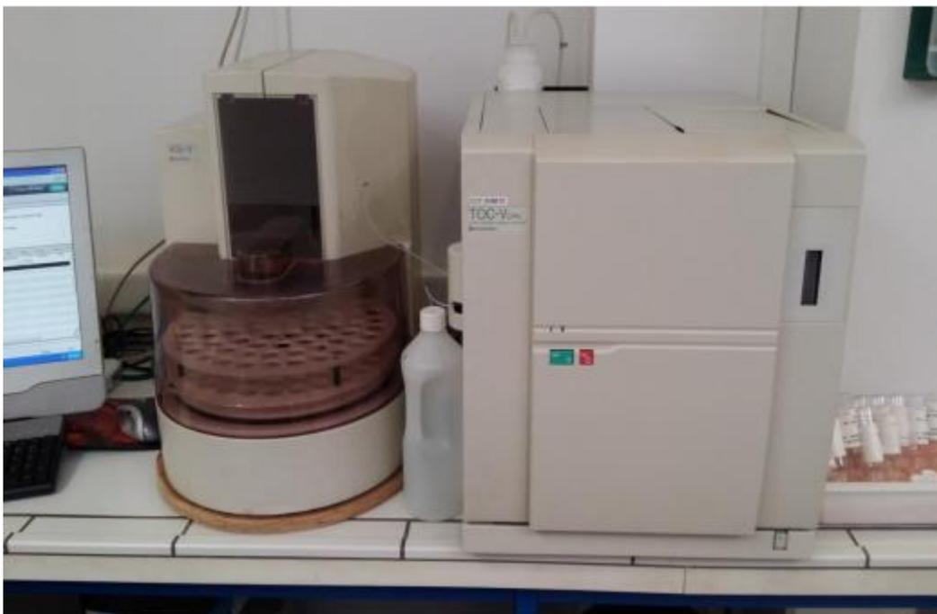
**Figure 12 : Appareil de mesure du COT**
