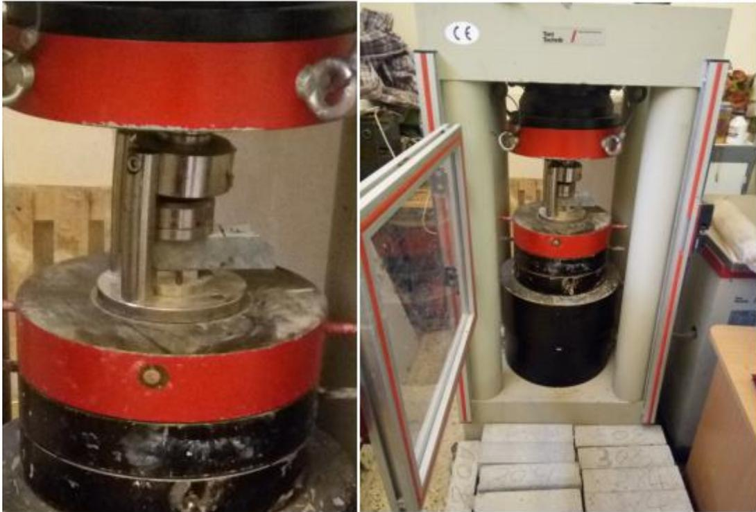
Figure 19 : Machine pour essais de flexion/compression
