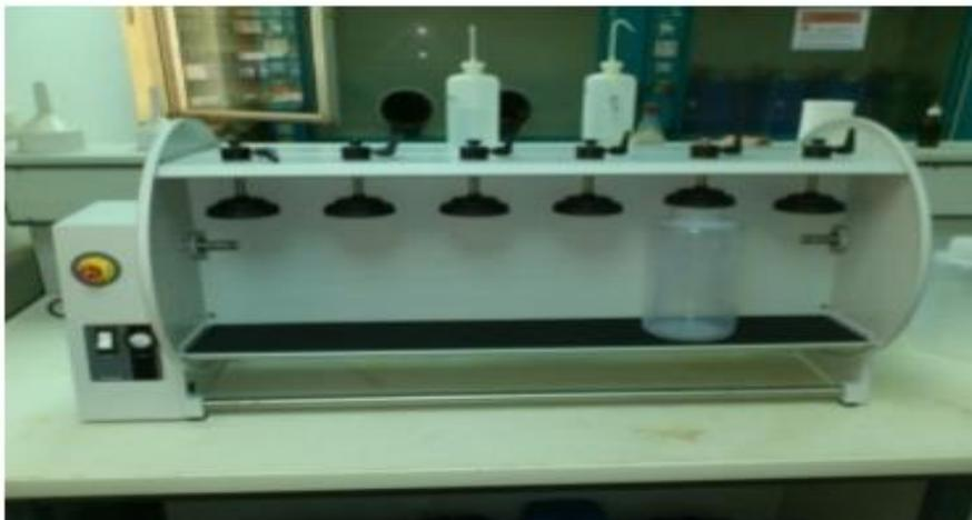
**Figure 9 : Dispositif d'agitation pour l'essai de lixiviation**
