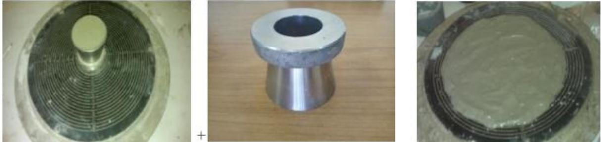
Figure 15 : Test de fluidité par mini-cône
