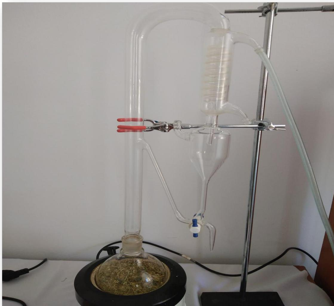
**Figure 19** : dispositif d'extraction de l'huile essentielle par Hydrodistillation avec Clevenger
