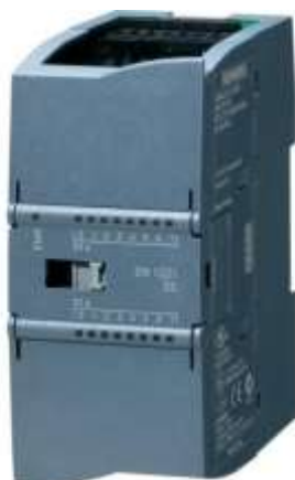
Figure 4.8 : Module SM 1221 DI16 x DC24V [16].
