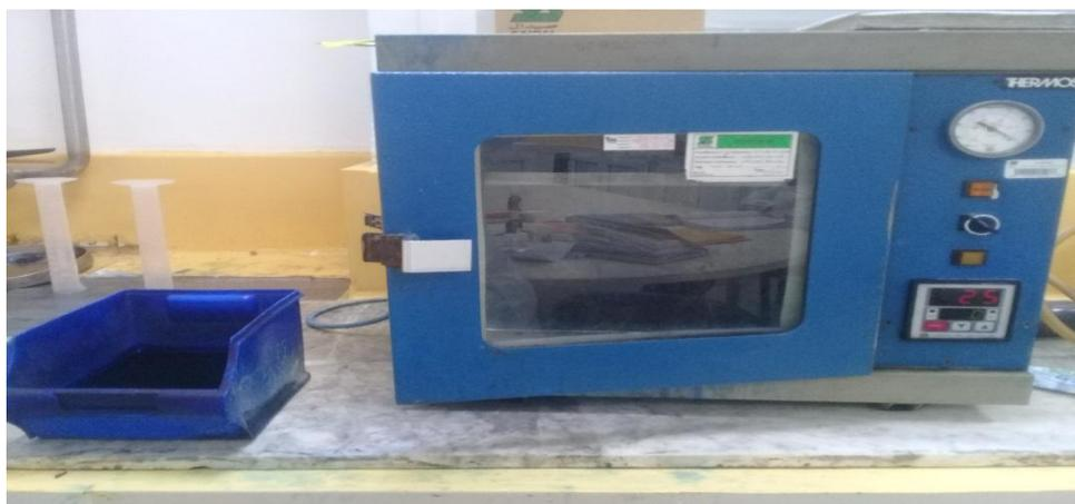
**Figure 9** : Bleu de méthylène et l'étuve type (FERMOB)
