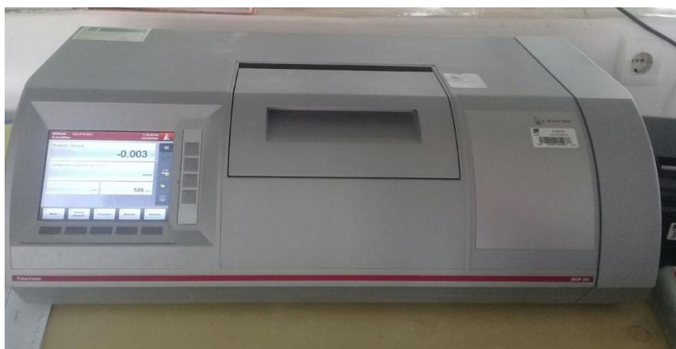
**Figure 2 :** Polarimètre
