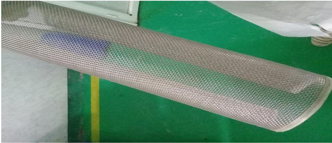
**Figure 8 :** Tamiseur type (FRWITT) ouverture de maille 1.5 mm
