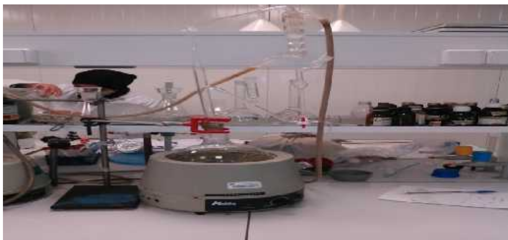
Figure II.02: Dispositif d'hydrodistillation utilisé à l'échelle du laboratoire.
