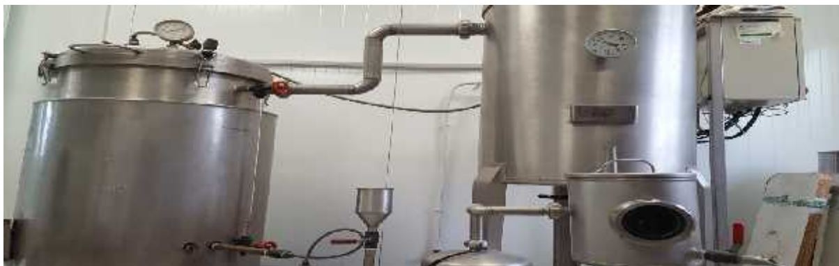
Figure II.04: Dispositif d'extraction par entraînement à la vapeur d'eau utilisé à l'échelle pilote.
