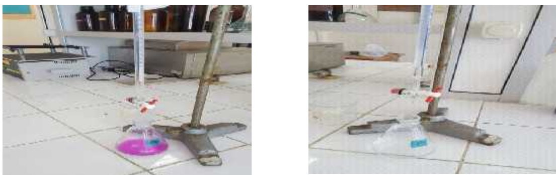
Figure II.10: Test témoin pour la détermination d'indice de saponification.
