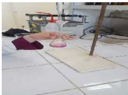
Figure II.07: Image représentant le processus expérimental de détermination d'indice acide.
