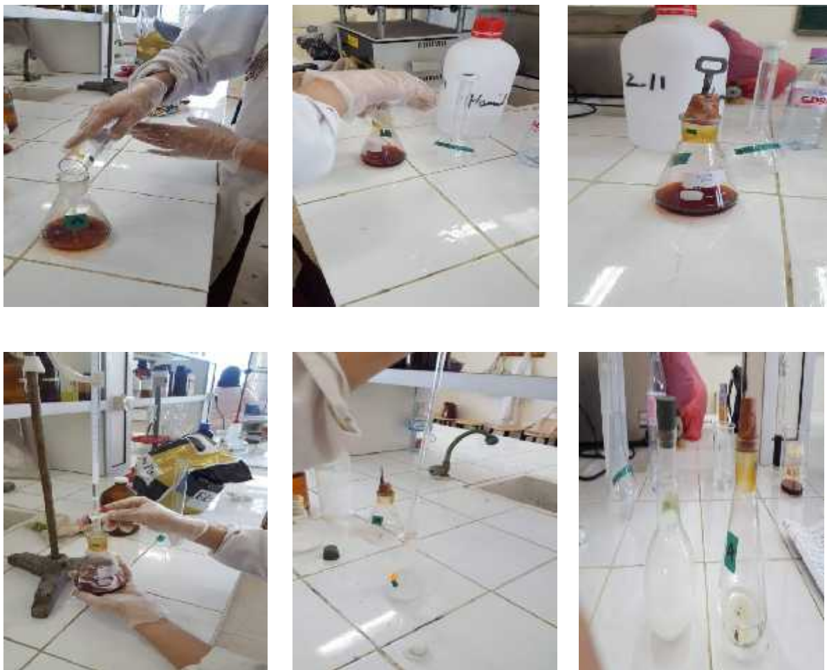
Figure II.11: Images représentatifs du processus expérimental de détermination de l'indice d'iode.
