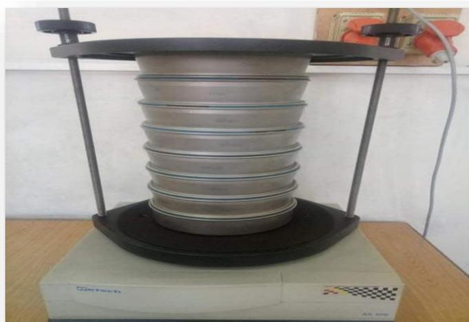
**Figure 22 :** Tamiseuse d'analyse pour tamisage à sec
