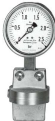
**Figure 2.6 :** Capteur différentiel de pression
