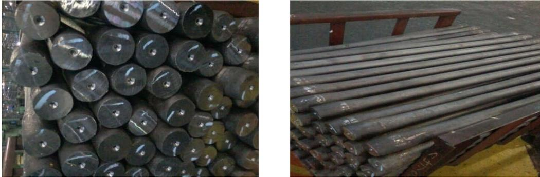
*Figure .1.1. Pièces après fraisage et centrage sur M3T*
