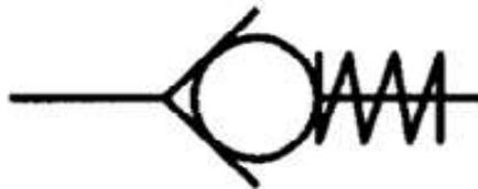
*Figure .2.14. Symbole du clapet anti retour taré*
