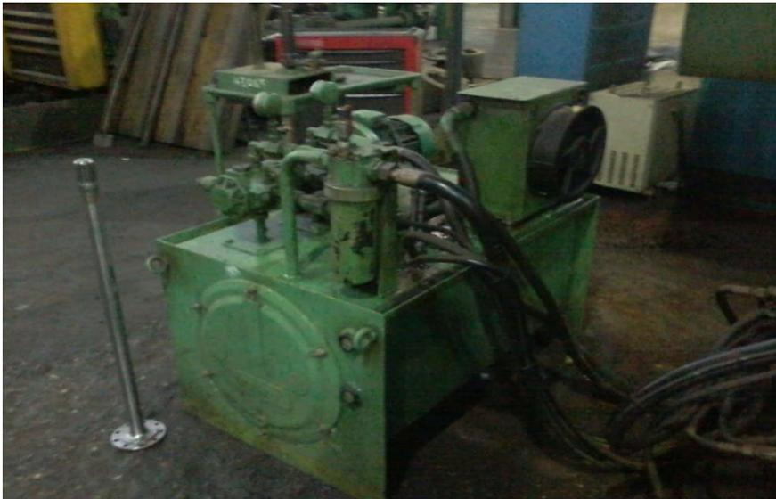
*Figure .1.7. Illustration du groupe de commande hydraulique*
