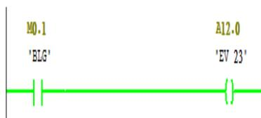
Figure. 4.10. Langage contact (ladder) pour le blocage du groupe
