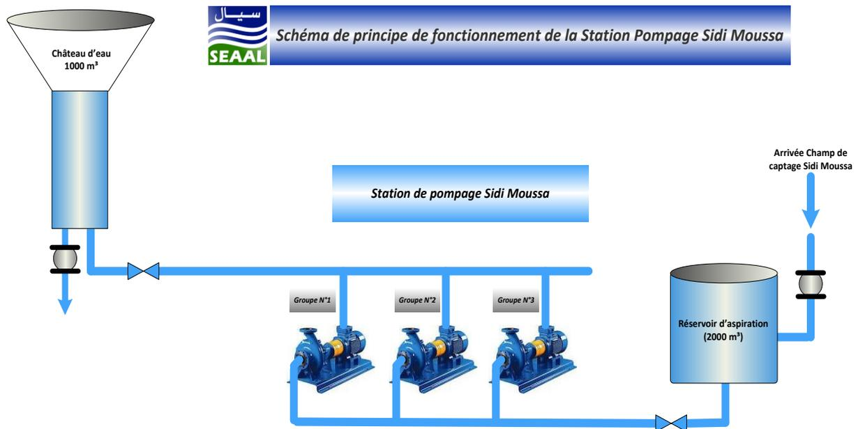
**Figure 1.6 :** schéma de principe de fonctionnement de la station pompage sidi moussa
