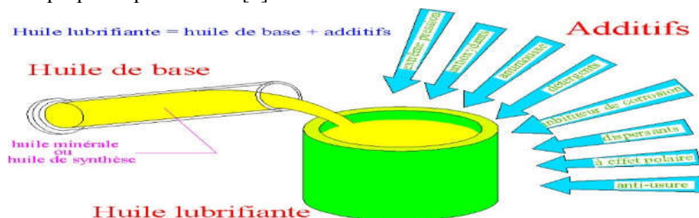
Figure II.1. Composition d'une huile lubrifiante
