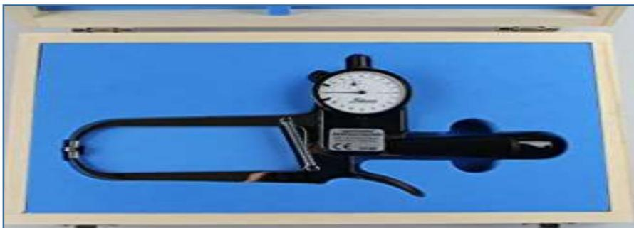
**Figure N°II.4 :** Pince à plis (ou caliper) de type Harpenden
