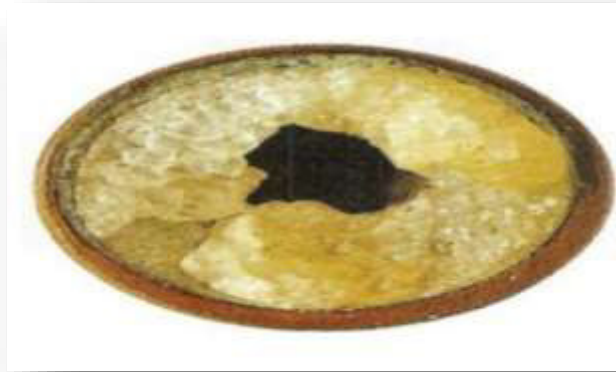
Figure 6: Dépôt de Chlorure de Sodium.
