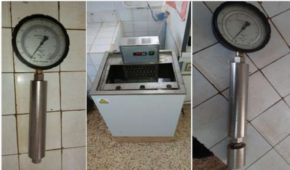
Figure 2: Bombe pour la mesure de la tension de vapeur.
