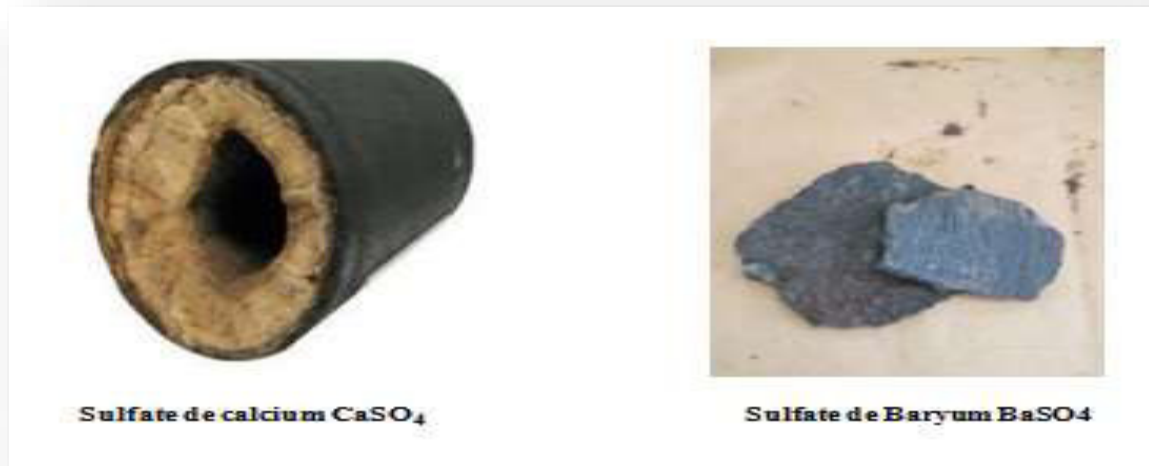
Figure 7: Dépôts de sulfates.
