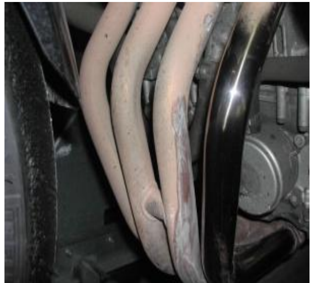
Figure II.2: Mécanisme de la corrosion atmosphérique: exemple de la corrosion d'un collecteur d'échappement [20].
