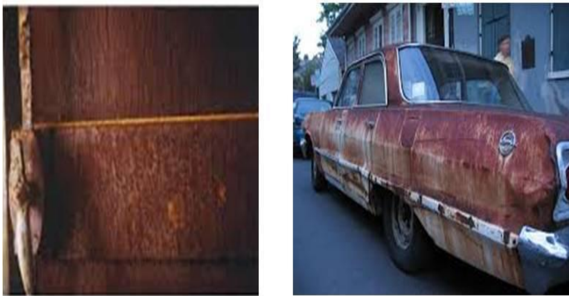
Figure II.5: Corrosion généralisée: exemple d'une porte et d'un véhicule corrodés [23].
