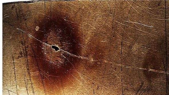
**Figure I. 4 :** Corrosion par piqûres sur la paroi d'une cuve en acier inoxydable austénitique Cr18-Ni10 [11].
