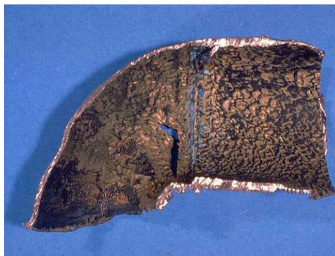
**Figure I. 8 :** Corrosion-érosion d'un tube en cuivre véhiculant de l'eau [11].
