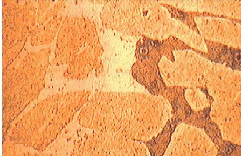
**Figure I. 7 :** Coupe métallographique montrant une corrosion sélective d'un laiton [11].
