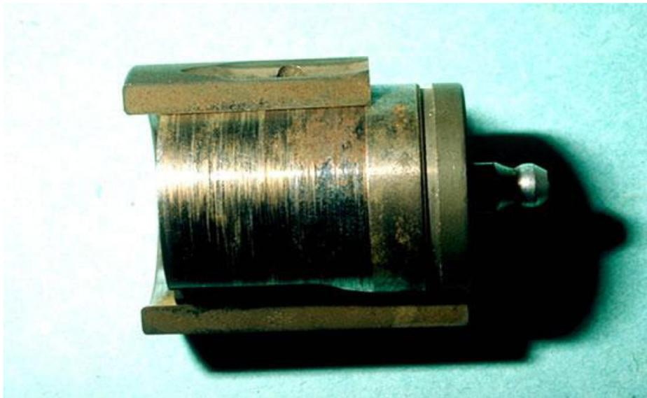
**Figure I. 9 :** Corrosion par frottement d'une pièce en acier [11].
