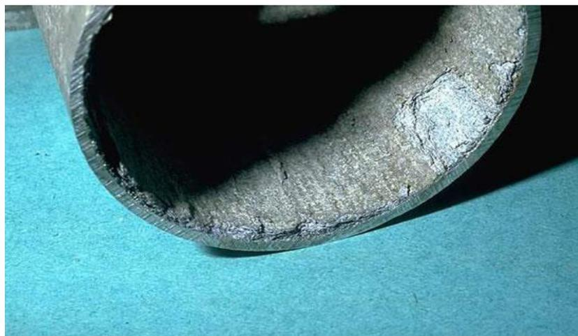
**Figure I. 5 :** Corrosion feuilletant d'une canalisation en alliage d'aluminium véhiculant de l'eau [11].
