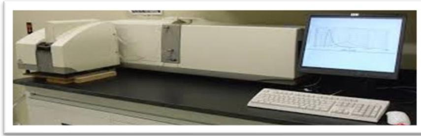
**Figure IV.2 :** Granulomètre par diffraction laser.
