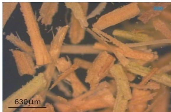
**Figure IV.3 :** Photomicrographie des tiges d'Alfa avant adsorption (X50).
