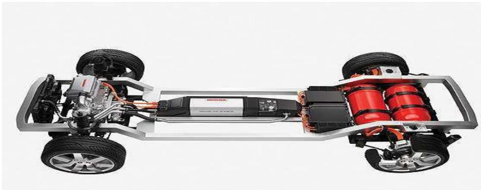
Figure.2.7 : L'arrangement des composants sur le véhicule Honda FCX (document Honda, 2005)
