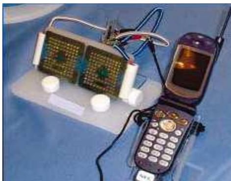
**Figure.I.13 :** Un système à pile à combustible utilisé pour un téléphone portable [2]
