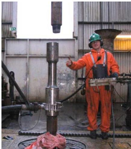
**Figure VI.07** Connexion des tiges avec un e-CD Sub pendant une circulation continue
