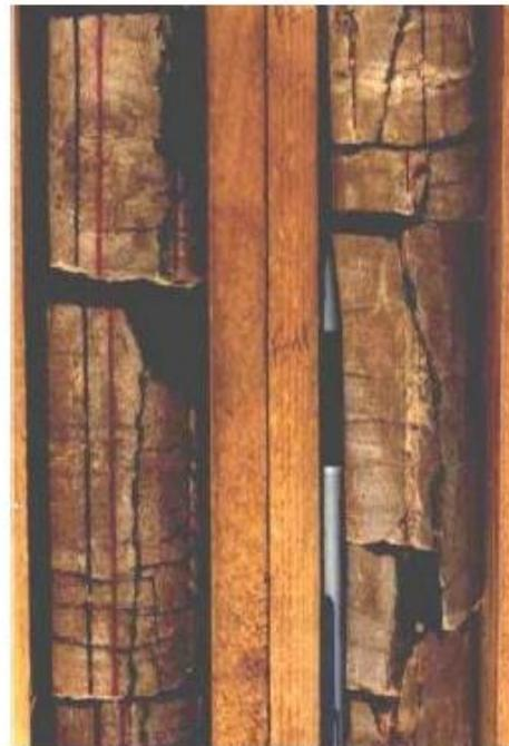
Réseau de fracture colmaté par la pyrite et localement par la silice et les carbonates sur HDZ
