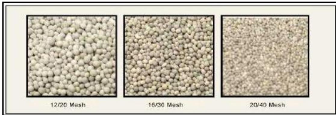
Figure V.32 : Différentes granulométries des agents de soutènements
