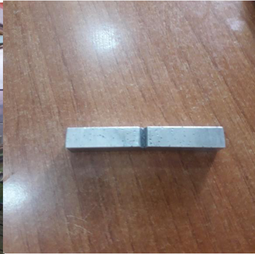
Figure II. 22 : Eprouvettes avant éssai de résilience.
