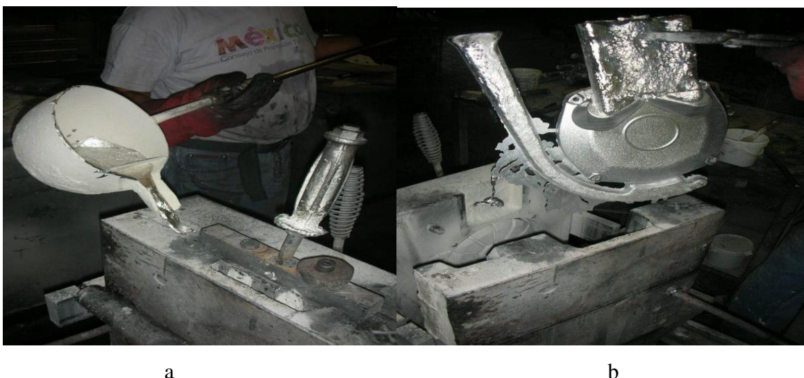
Figure I.16 : (a) coulée de l'alliage d'aluminium en fusion, (b) sortie de la pièce.
