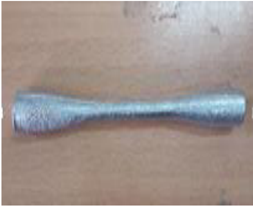
Figure-II.16 : Eprouvettes avant essai.
