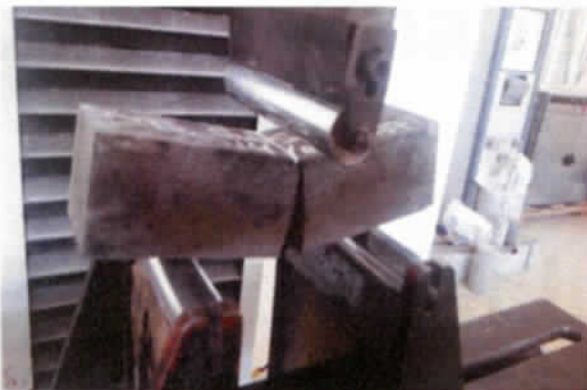
Figure.IV.7: Essai de traction par flexion et à la compression
