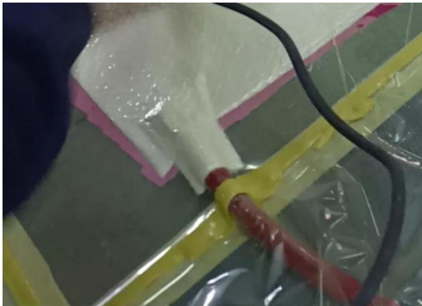
**Figure III.23 :** Tuyau de la pompe à vide
