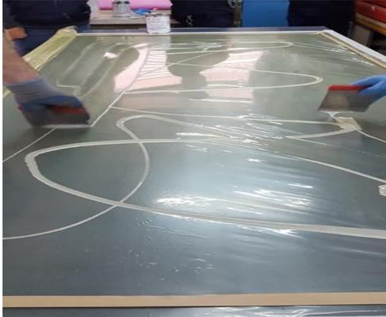
**Figure III.18 :** Etalement de la résine
