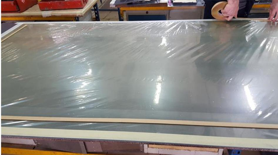
**Figure III.15 :** Un film de mise sous vide
