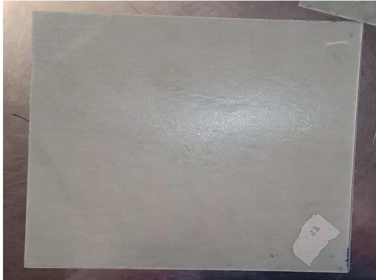
**Figure III.28 :** Stratifier après démoulage
