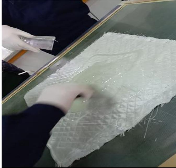
**Figure III.20 :** Etalement de la résine
