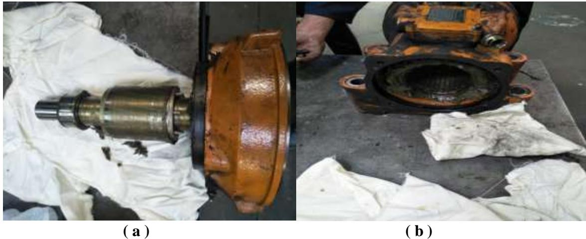
**Figure 4.19** : nettoyage de moteur
