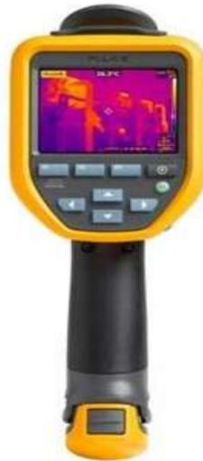
**Figure 4.5 :** caméra thermique
