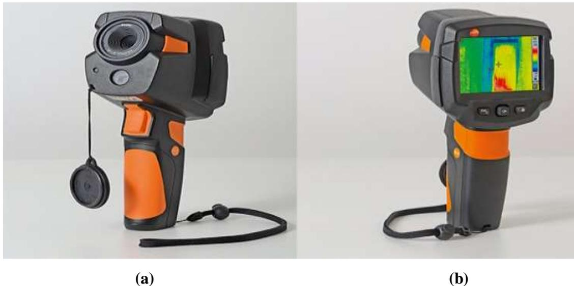
**Figure 4.2 :** caméra infrarouge ; **(a)** : vue d'utilisateur. **(b)** : vue de face.
