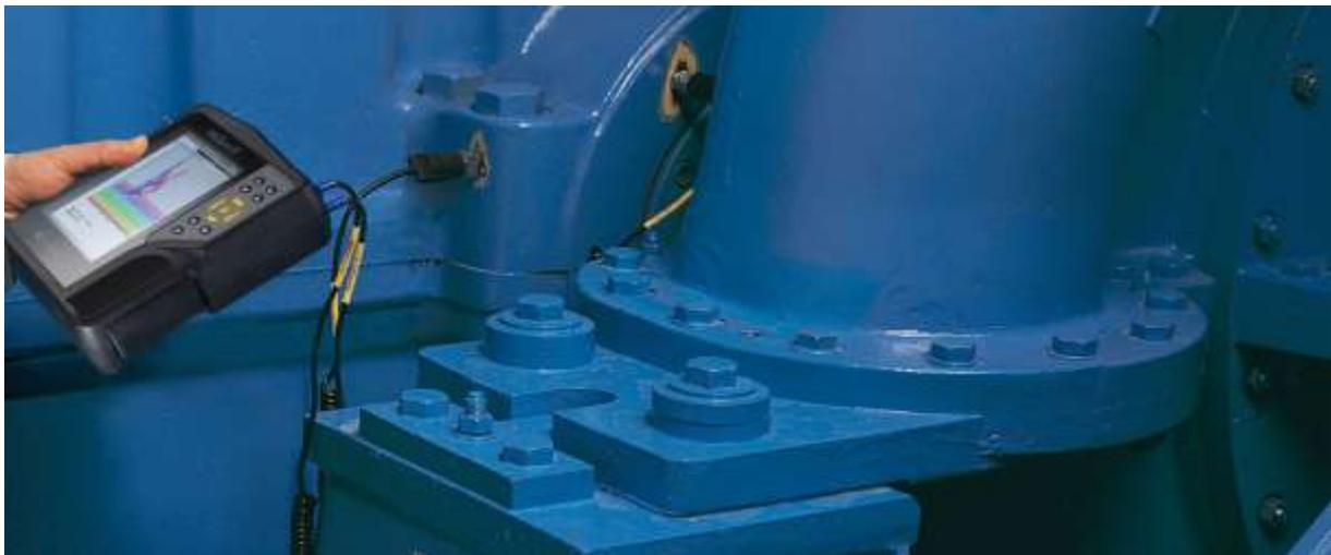
**Figure 4.1 :** Analyse des vibrations
