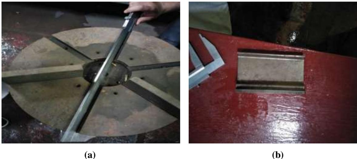
**Figure 5.1** : présentation de la turbine de la grenailleuse ; (a) : turbine. (b) : aile de turbine
