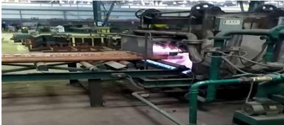
**Figure 2.2 : Préchauffage**
