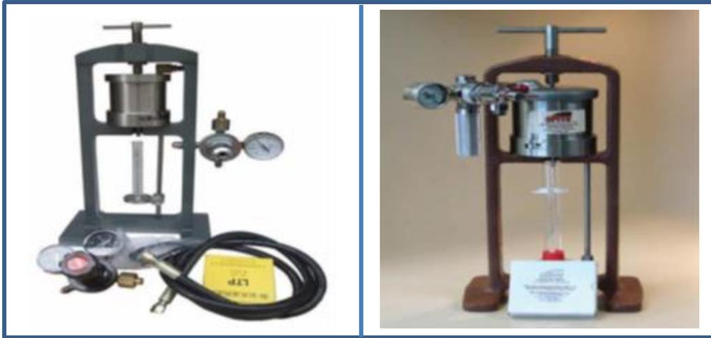
Figure -12- : Filtre-presse API, Filtre-presse haute pression et haute température [2]
