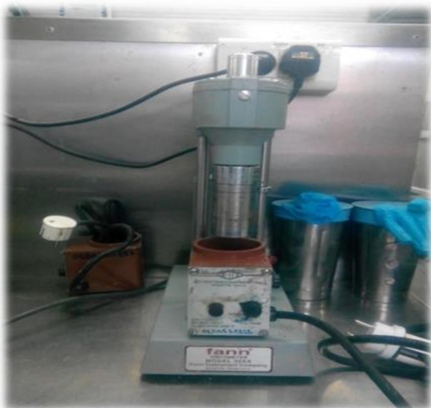
Figure -38- : Appareil de mesure de la viscosité plastique
