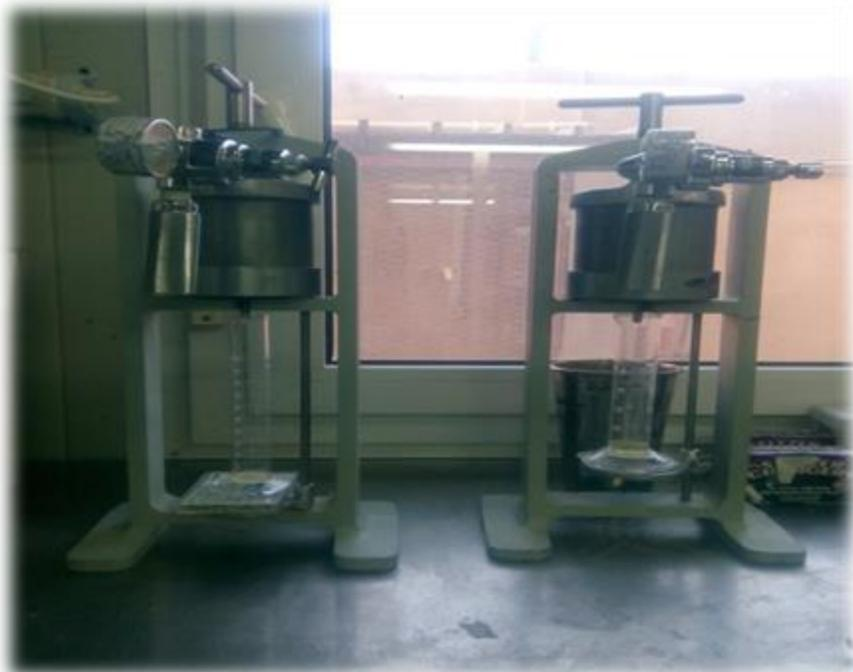
Figure -37- : Dispositif de mesure du Filtrat API
