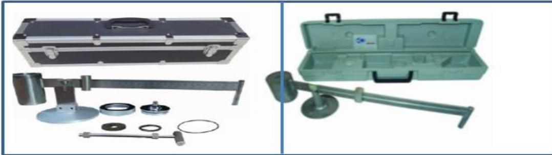
Figure -2- : *Densimètre pressurisé.* [2]      Figure -3- : *Densimètre Classique.* [2]
