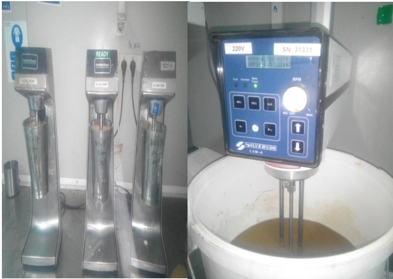
Figure -36- : Dispositif de préparation des boues
