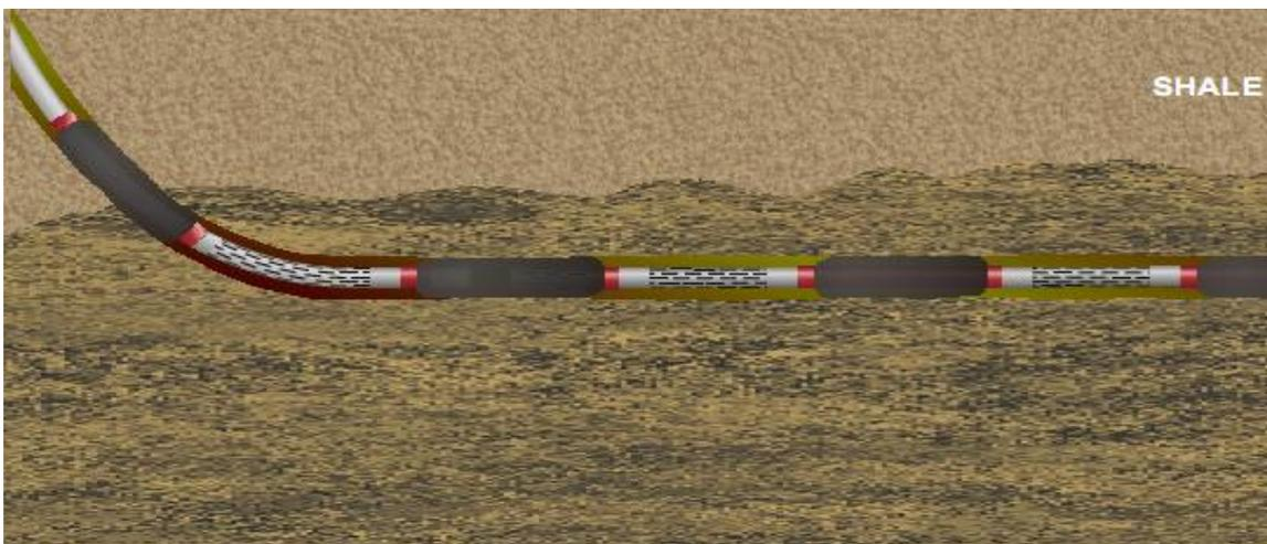
***Fig.36:*** Fournir la ségrégation dans des zones horizontales.
