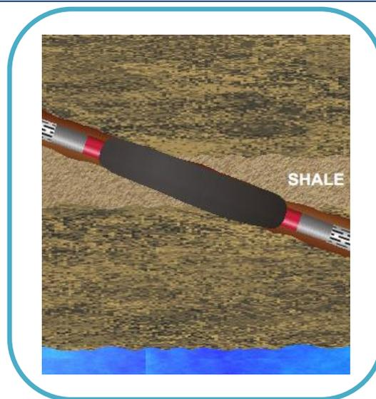
**Fig.37: Isolement des zones de production.**
