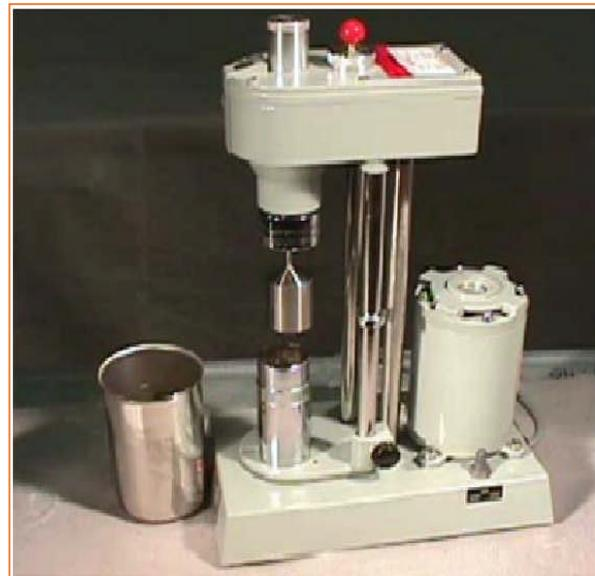
Figure.14: Viscosimètre fann Model 35A 6 Speed V-G Meter
