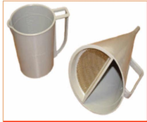
Figure.13 : Viscosimètre Marsh
