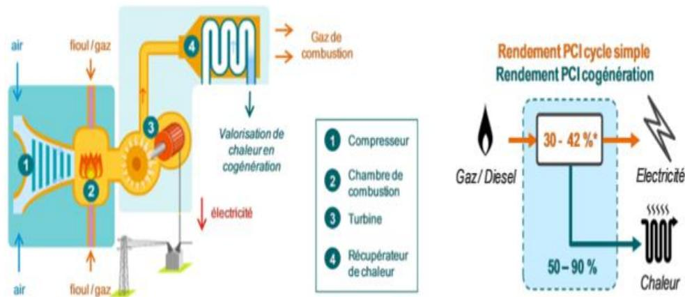
**Figure I.4 :** Schéma de principe de fonctionnement d'une TAC
