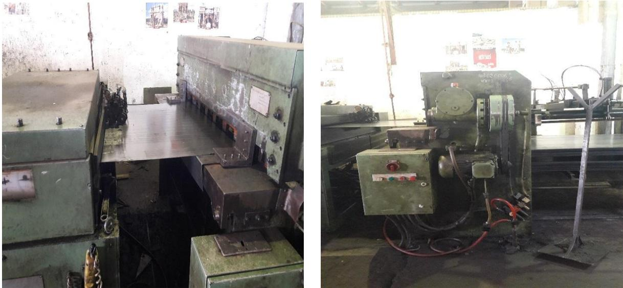
Fig. III. 6 : Cisaille à guillotine
