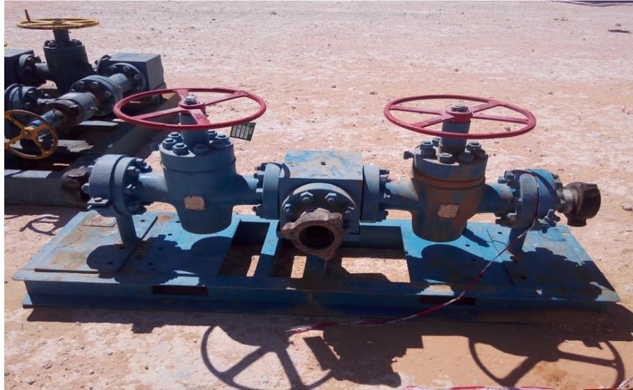
**Fig IV-3 : Manifold de gaz**
