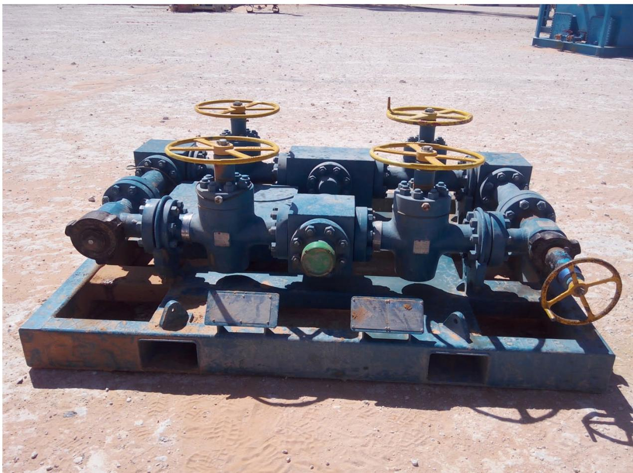
**Fig I-6 : Le manifold de duses**
