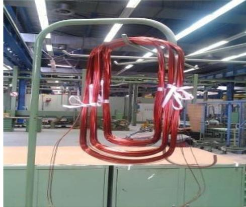
**Figure I. 12: Préparation des bobines.**
