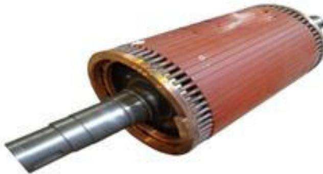
**Figure II. 3: Rotor à cage d'écureuil**
