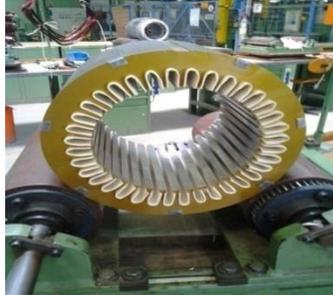
**Figure I. 14: Stator avec caniveaux d'encoches isolés**
