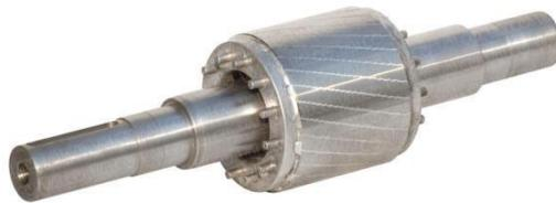
**Figure I. 11: Arbre emmanché dans le paquet rotorique**
