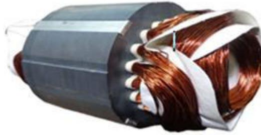
**Figure I. 15: Stator bobiné d'un petit moteur**
