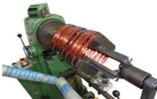
**Figure I. 13: Bobineuse de fil électrique**
