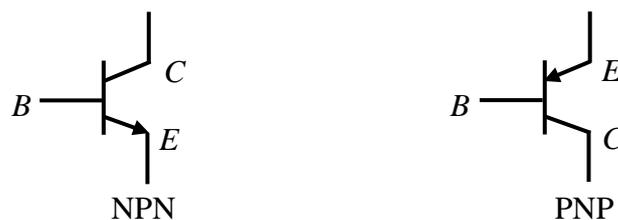
Figure II.5: Structure d'un transistor [12]
