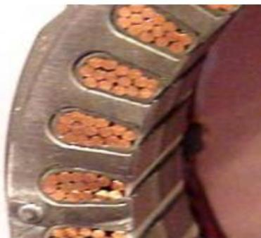
**Figure 2.2 : Coupe stator[2]**
