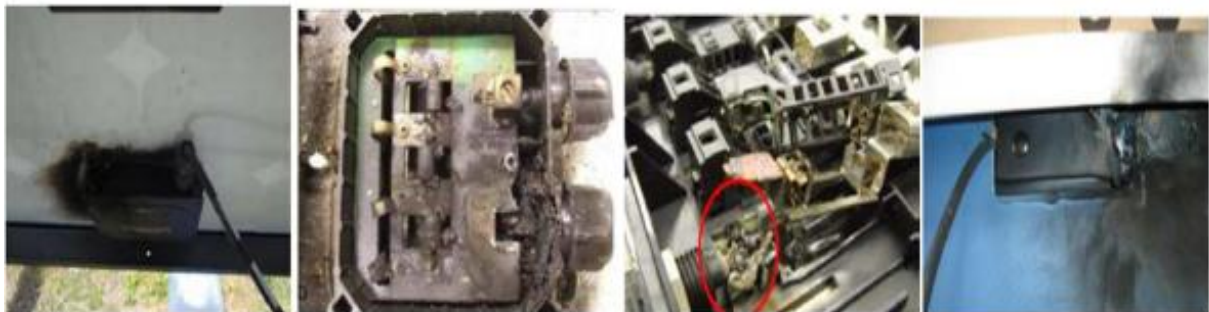
Figure III.3: Exemples de défauts rencontrés dans les boîtes de jonction
