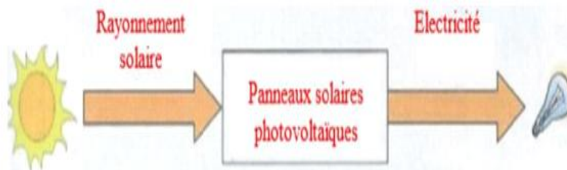
Figure I.2: Principe de la conversion photovoltaïque de l'énergie solaire
