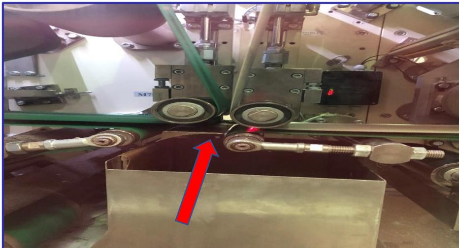
*Fig.3. 8: Positionnement de plaque de rejet.*
