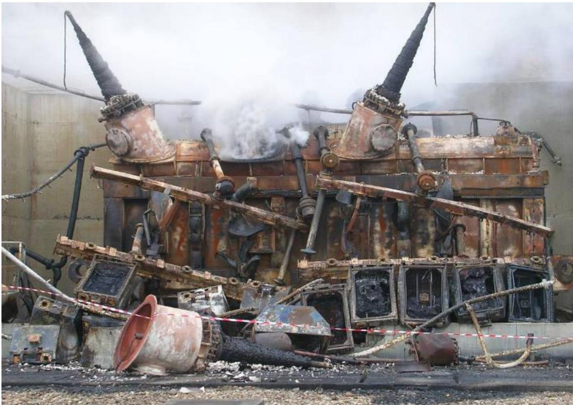
**Figure III.1:** Explosion de transformateur.
