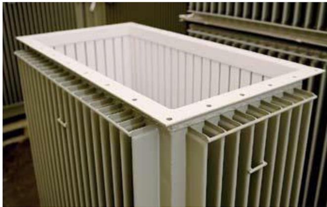
Figure I.12 : La cuve d'un transformateur de puissance.
