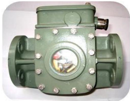
**Figure IV.3:** la protection Buchholz du régleur en charge.
