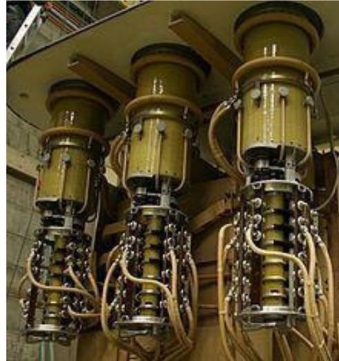
**Figure I.18 :** Changeur de prise.
