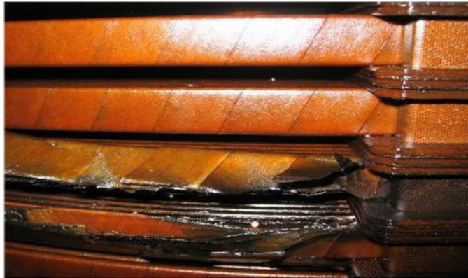
**Figure III.10** : Amorçages entre spires d'un même enroulement.
