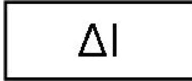
Figure IV.4 : Symbole CEI d'une protection différentielle.
