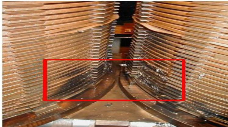
**Figure III.9 :** Amorçages entre deux enroulements.
