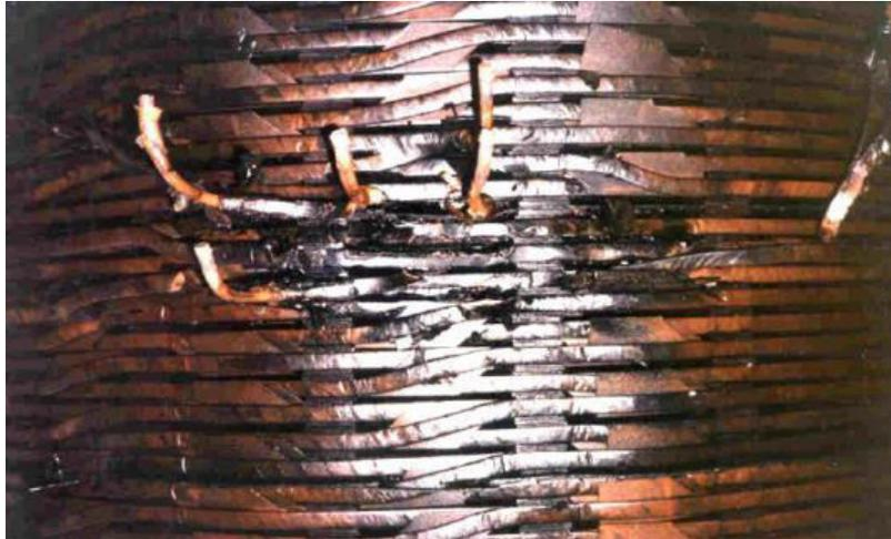
**Figure III.3:** Déformation de l'enroulement.
