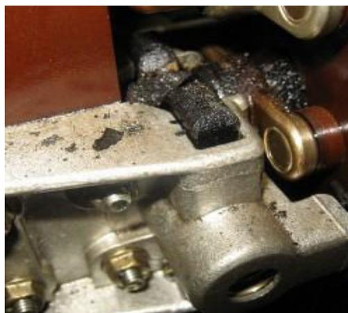
**Figure III.12 :** Point chaud régleur.
