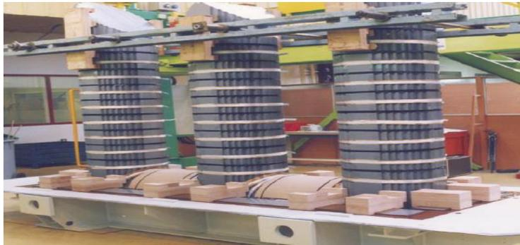
**Figure I.23 :** Circuit magnétique colonne.
