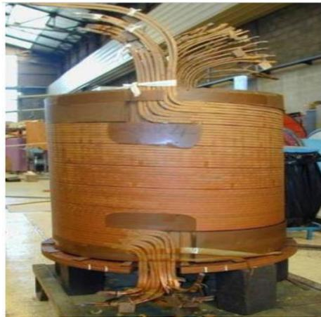
**Figure I.25 :** Enroulement d'un transformateur.
