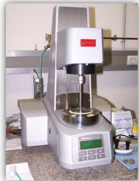
Figure n°23 : Rhéomètre Physica MCR 301
