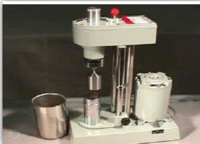
Figure n°09 : un viscosimètre Fann
