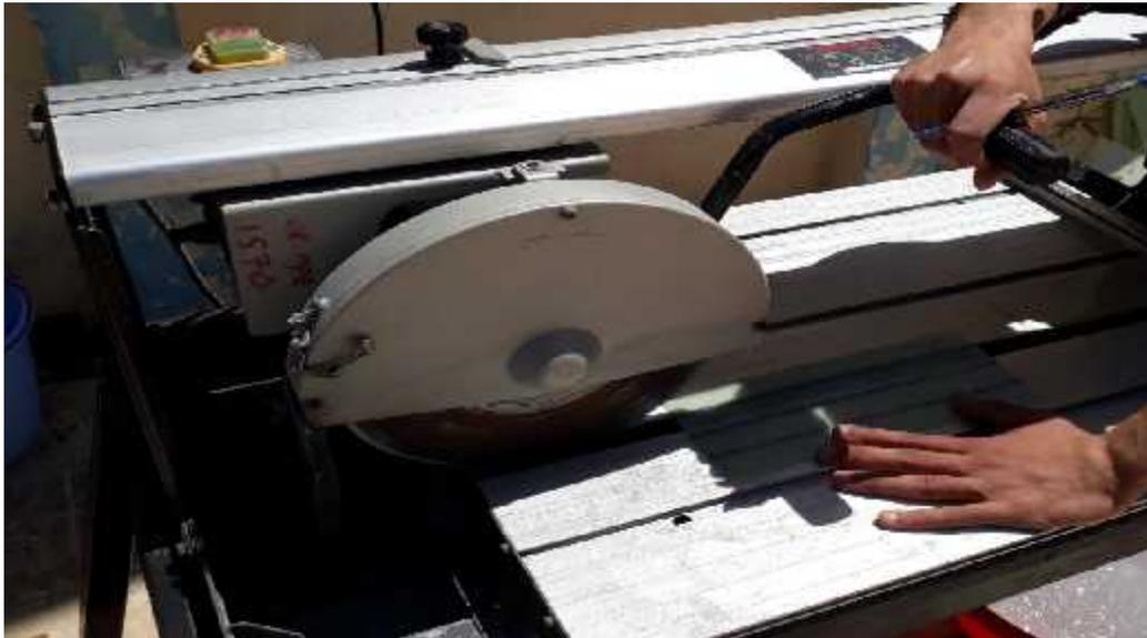
**Figure III.17** : Le moyen de découpage des plaques.
