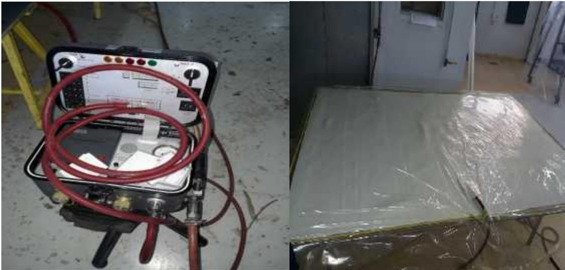
**Figure III.14 :** les épreuves branchés avec une pompe à vide.
