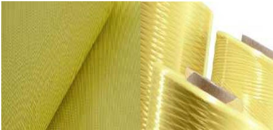
**Figure I.9:** Fibre d'aramide.
