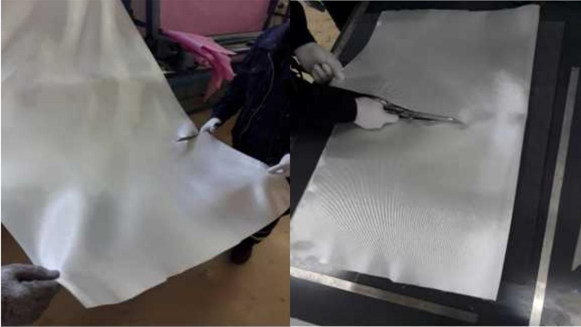
**Figure III.2 :** Tissu de verre découpé selon la géométrie de l'éprouvette.
