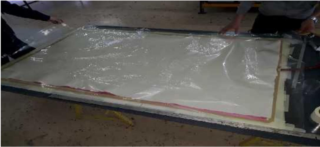
**Figure III.13 :** Eprouvette recouvert avec un nylon.
