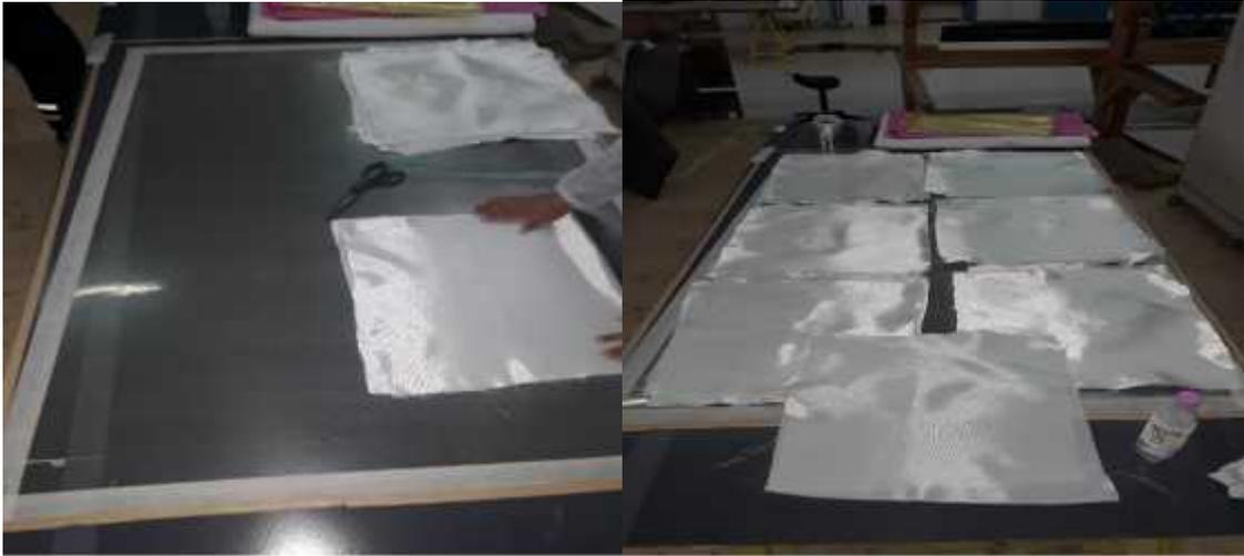
**Figure III.9** : préparation des tissus sur la table (le nylon).
