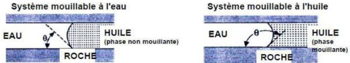
Figure II.16 : La Mouillabilité dans le réservoir (Document IFP, 2014).
