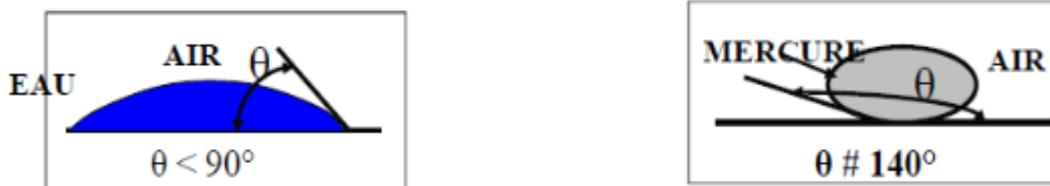
**Figure II.15** : illustration de l'angle de contact pour l'eau et le mercure
