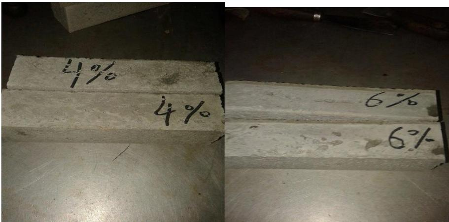
**Figure IV.6 :** les éprouvettes de mortiers avec 4% et 6% de nano-silice
