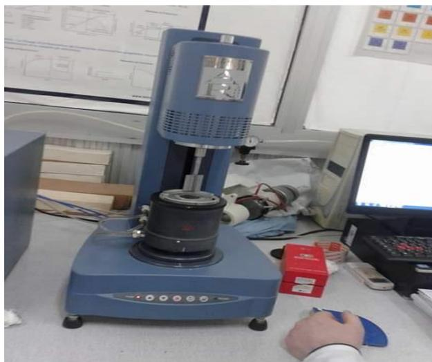
**Figure III.3 : Le rhéomètre**
