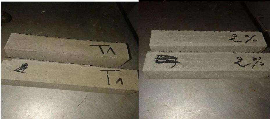
**Figure IV.5 :** les éprouvettes de mortier témoin et de mortier avec 2% de nano-silice
