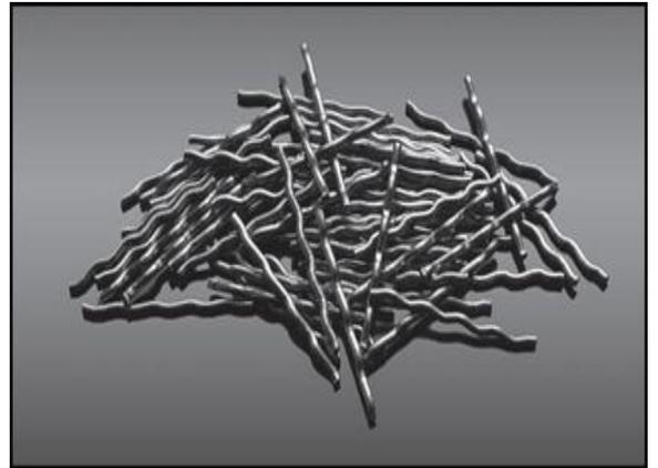
Figure II-2 : Les fibres métalliques.
