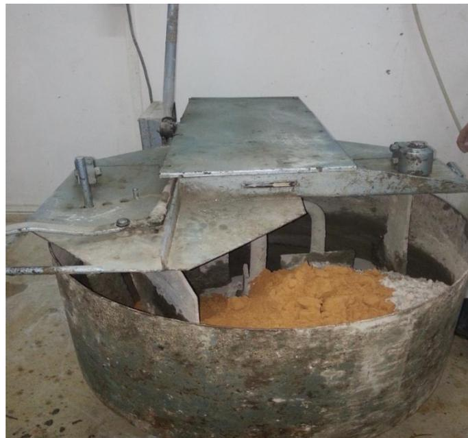
**Figure IV-16:** Malaxeur de béton
