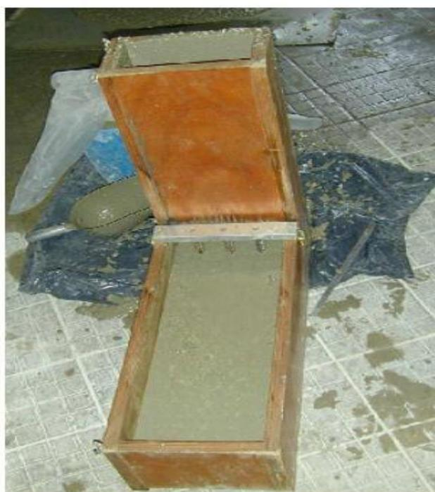
**Figure IV-18 :** Essai de la boîte en L
