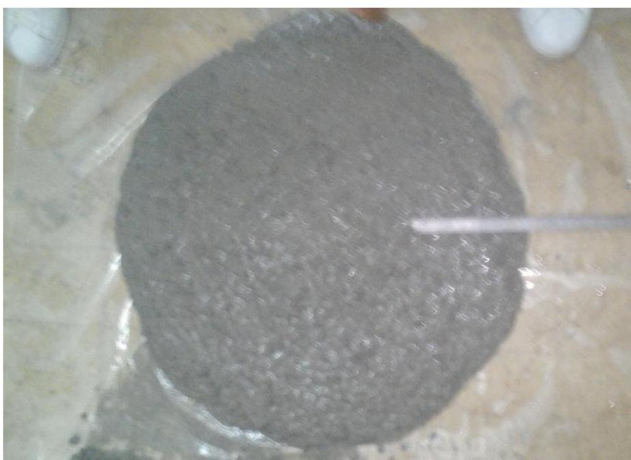
**Figure IV-17 :** Essai d'étalement sur béton autoplaçant.
