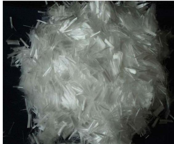
**Figure II-4 :** Les fibres de polypropylènes.
