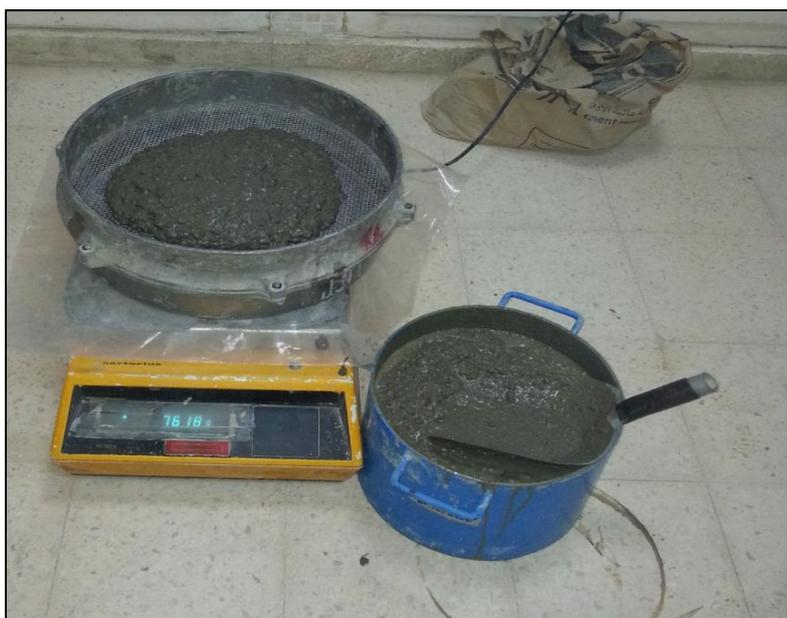
**Figure IV-19 :** Essai de stabilité au tamis.
