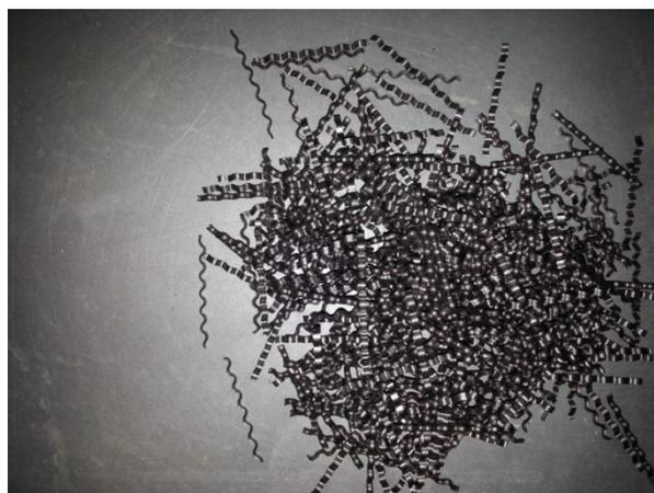
**Figure IV-9 :** Fibre métallique
