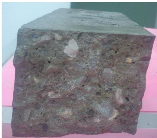
**Figure I- 8** : la ségrégation du béton.
