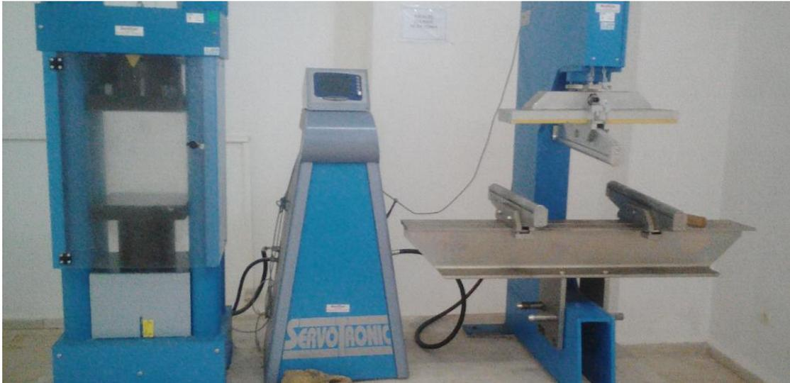
**Figure I- 9:** l'appareil pour déterminer la résistance à la traction
