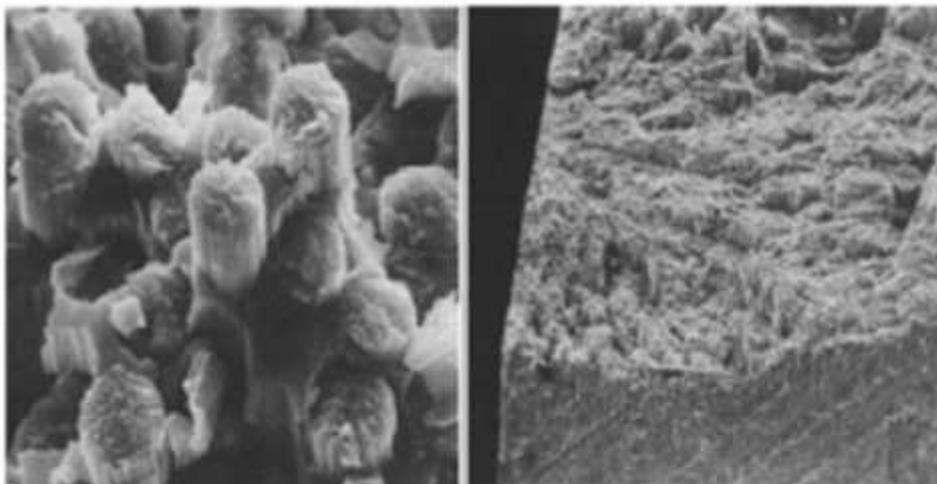
**Figure II.9 : Surface de rupture associée à une bonne adhérence fibre-matrice dans le cas d'un composite à fibre de carbone. [23]**
