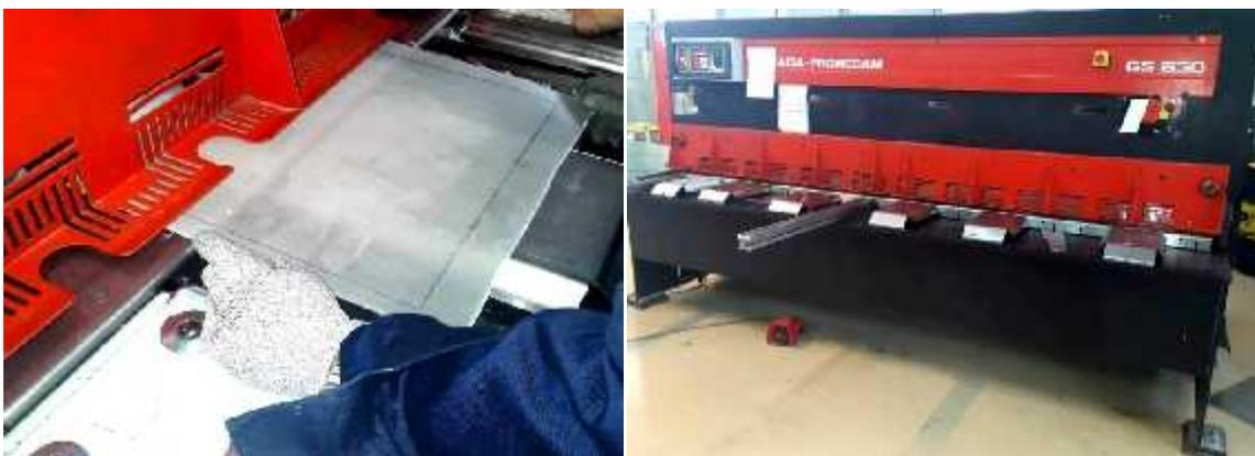
**Figure III.24 : Découpage des plaques avec guillotine automatique**
