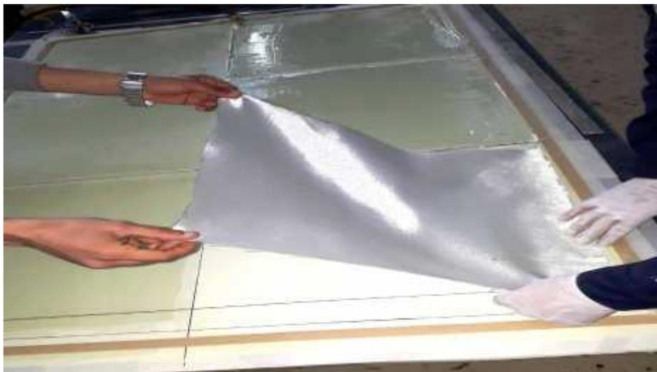
**Figure III.18 : Pose du 1<sup>er</sup> pli**
