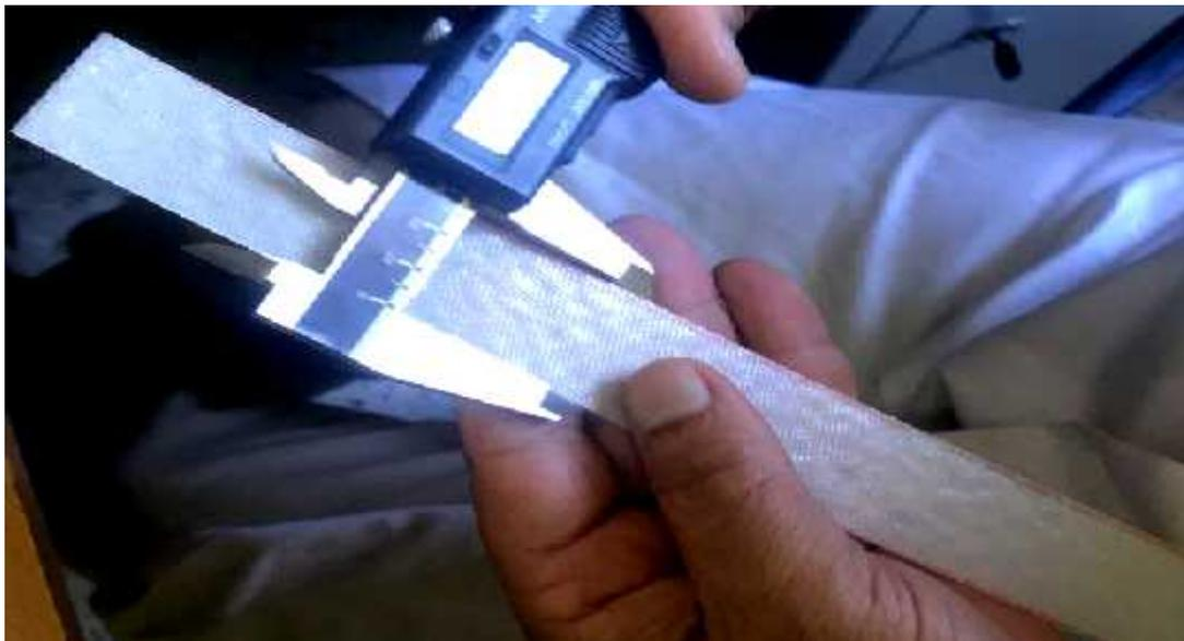
**Figure III .26. Echantillons d'éprouvette de dimensions 250 x 25 mm pour les essais de traction**
