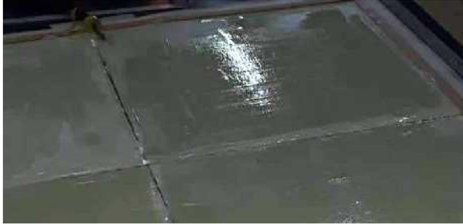
**Figure III.17 : Application de la résine sur le moule**
