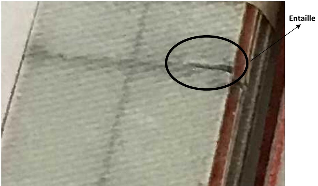
Figure III.27 : Eprouvettes avec fissures
