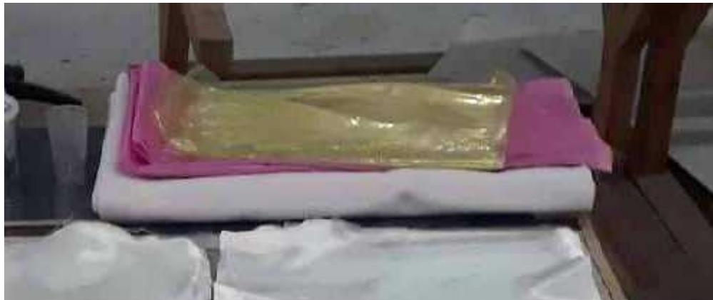
**Figure III.14 : Préparation du tissu d'arrachage et du sac à vide**
