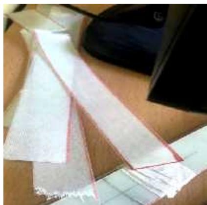
**Figure IV.2 :** Éprouvettes après les essais de traction.
