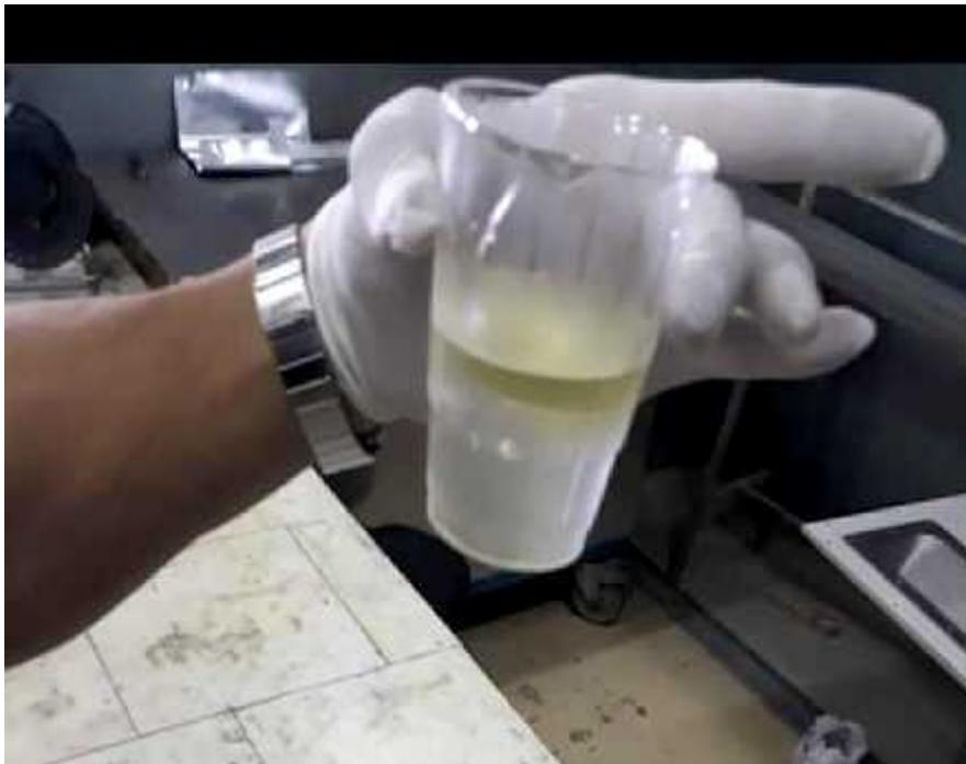
**Figure III.16 : Mélange de la résine (Epocast) avec le durcisseur (Hardener)**
