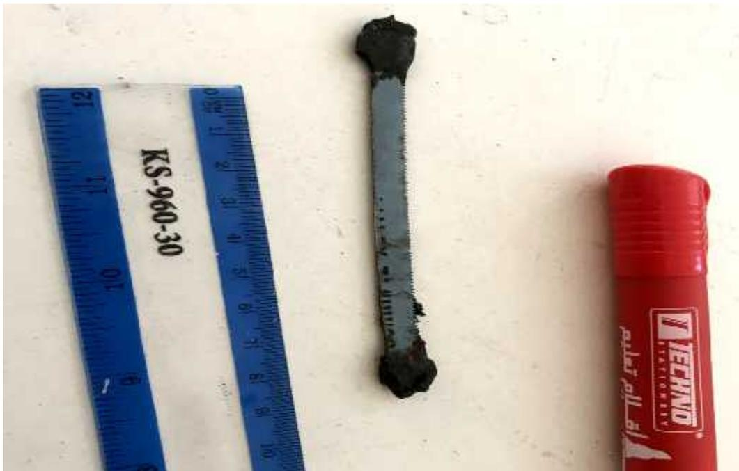
Figure III.28 : Outils pour tracer et couper l'éprouvette.
