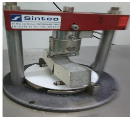
Figure V.09). Essai de traction par flexion.
