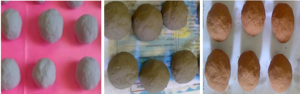
**Figure III.6).** Elaboration de différents types des granulats de verre mousse
