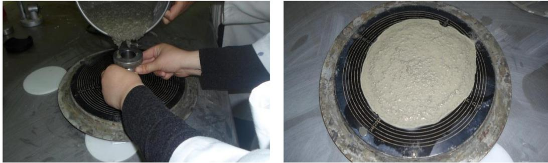
**Figure.V.1).**Essai d'étalement sur le mortier autoplaçant frais.
