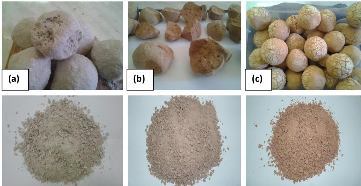
Figure III.9) Granulats de verre mousse (a) sans additif (b) avec 10% d'argile (c) avec 10% de chamotte
