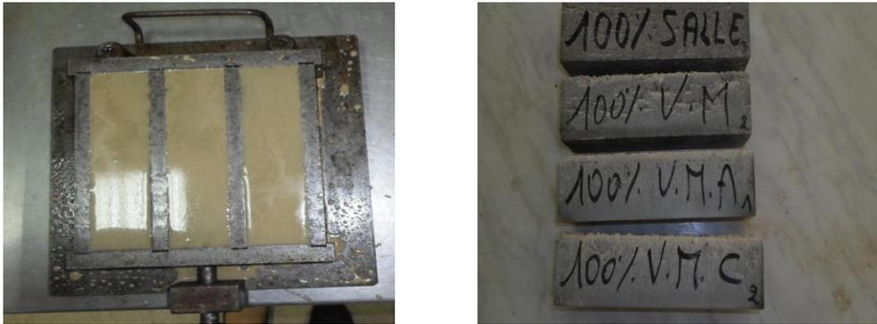
Figure V.4). Epreuve d'un mortier autoplaçant à l'état frais et durci.
