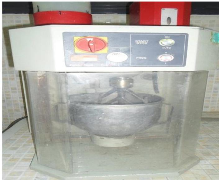
**Figure IV.1).** Malaxeur pour des mortiers autoplaçants.
