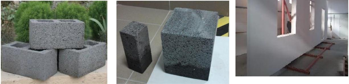
**Figure II.7)** Domaine d'application des granulats de verre mousse [22].
