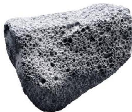
**Figure II.5) :** Granulat à base du verre mousse [17].
