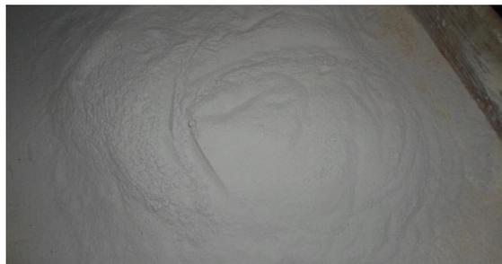
Figure III.5) Poudre de calcin 200 $\mu$ m
