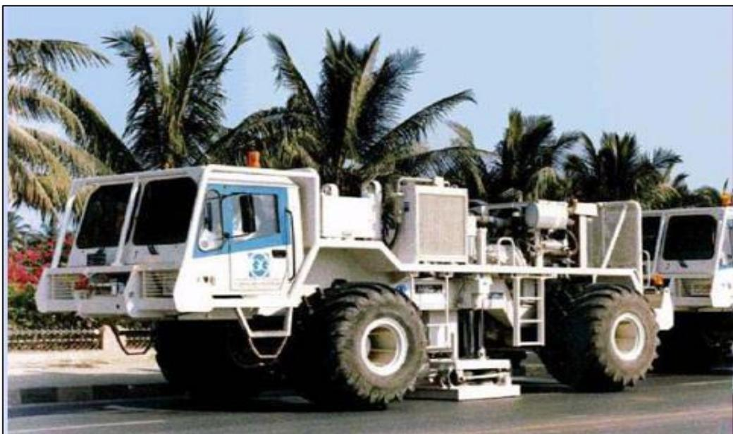
**Fig III-1** vibrateur d'acquisition
