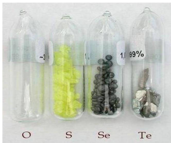
**Figure 23** : Quatre ampoules de verre contenant de l'oxygène, du soufre, du sélénium et du tellure purs [46].
